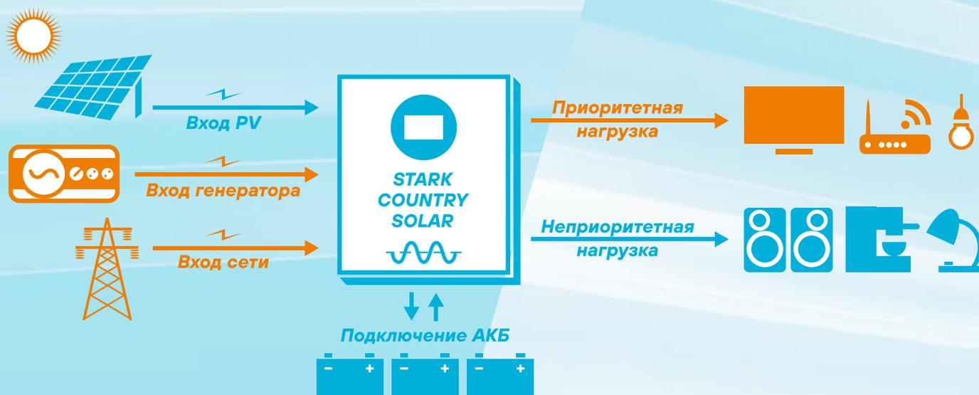
**2 независимых входа** позволяют подключать сеть и генератор к инвертору без использования АВР. Пользователь может самостоятельно задать приоритеты питания нагрузки от сети, генератора и солнечных панелей. Ток заряда аккумуляторов от входа генератора настраивается отдельно.
